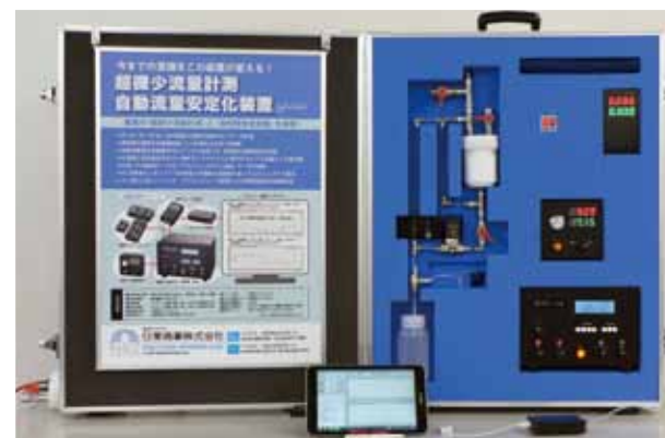
装置と溶液タンク、配管など一式を納めた機器ケース
